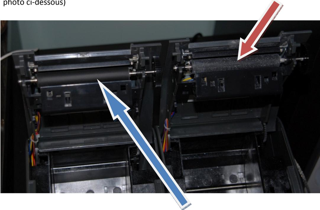
3. Appliquez le chiffon doux sur le rouleau en faisant tourner également le rouleau. Les résidus de papier doivent rester sur le chiffon. Le rouleau reprend ainsi son aspect initial. (cf. photo ci-dessus). Dépoussiérez également l'intérieur de l'imprimante et toute partie contenant des particules de papier.
