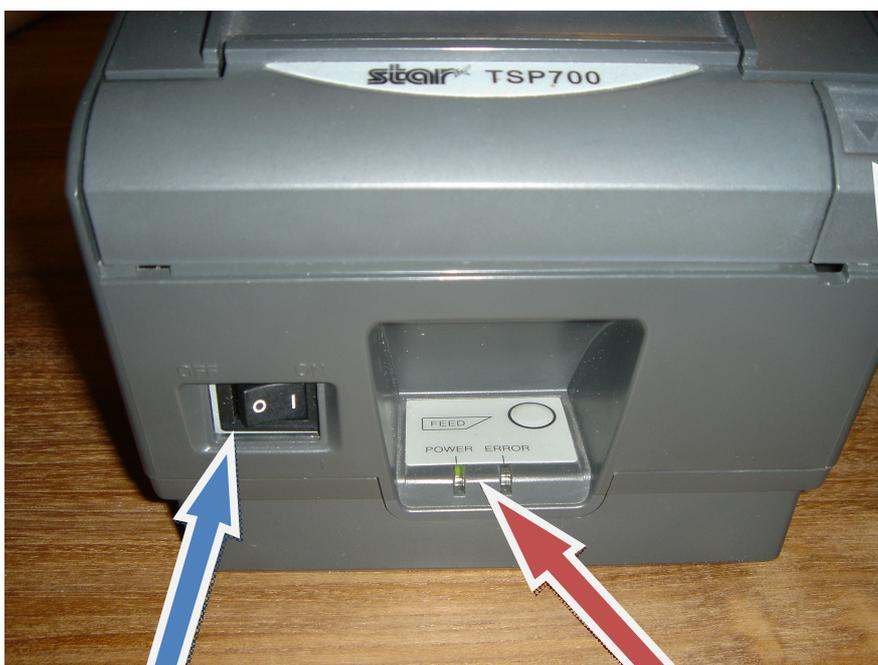
Interrupteur de mise sous tension
